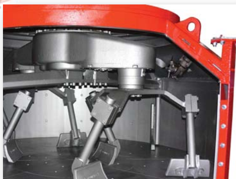
Tête A80R installée dans la couverture d'accès du mélangeur planétaire
