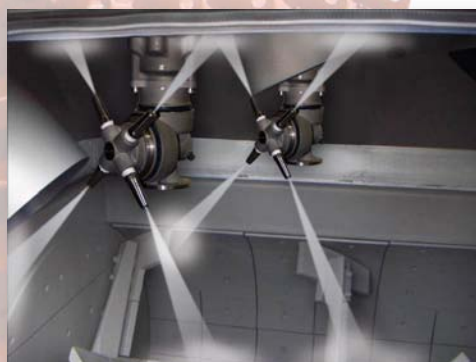
Têtes A80R installées dans un mélangeur à deux arbres
